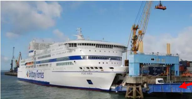
Au port de Brest, le ferry est positionné au quai roulier. Les rouliers sont des navires spécialisés pour le transport de voitures et d'autres véhicules montant à bord grâce à une ou plusieurs rampes d'accès. On les dénomme aussi RO-RO, de l'anglais roll-on/roll-off signifiant littéralement « rentrer en roulant, sortir en roulant ». Deux ports du Finistère sont équipés de ces passerelles : Brest et Roscoff
